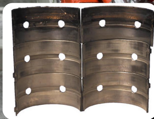
軸承溝槽（用作油封）磨損
