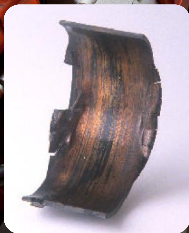
軸承因缺油而磨損
