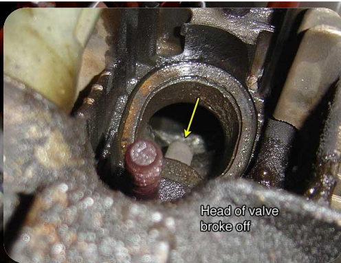
氣閥門頂部破裂
